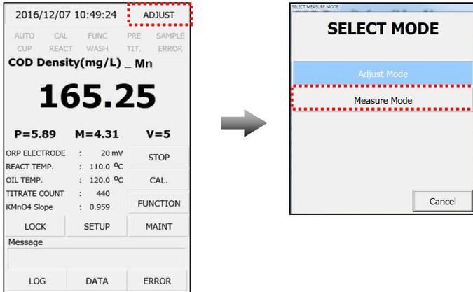
**주의!** 시각이 30 분 이전에 MEASURE MODE 상태로 되면 정시부터 측정을 개시합니다. 30 분 이후에 MEASURE MODE 상태가 되면 다음 정시까지 측정을 개시하지 않습니다.
