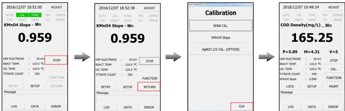
10) 출력된 SLOPE 값이 0.95 보다 낮으면 Na<sub>2</sub>C<sub>2</sub>O<sub>4</sub>에 증류수로 희석한 다음 MAIN > FUNCTION > Reagent Raise(F1)을 실행한 후
