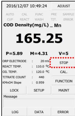
3) 장시간 장치를 정지시킬 경우에는 시약 TANK 의 시약 TUBE 를 빼고, MAIN > FUNCTION > REAGENT RASIE(F1)을 터치하여 배관내의 시약을 배출시킵니다.
