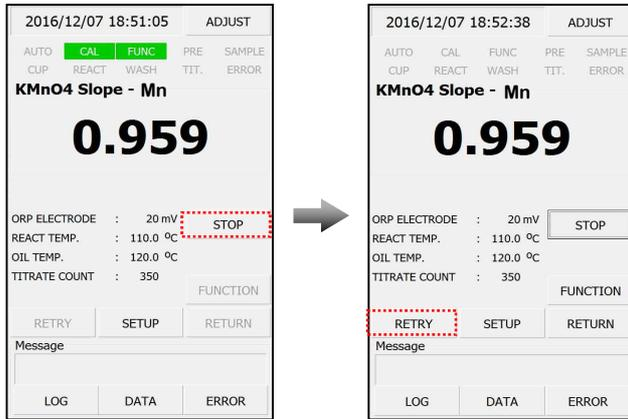
8) 출력된 KMnO<sub>4</sub> SLOPE 값이 0.95~1.02(최적 : 0.97~1.02)범위 내에 있는지 확인 합니다.
